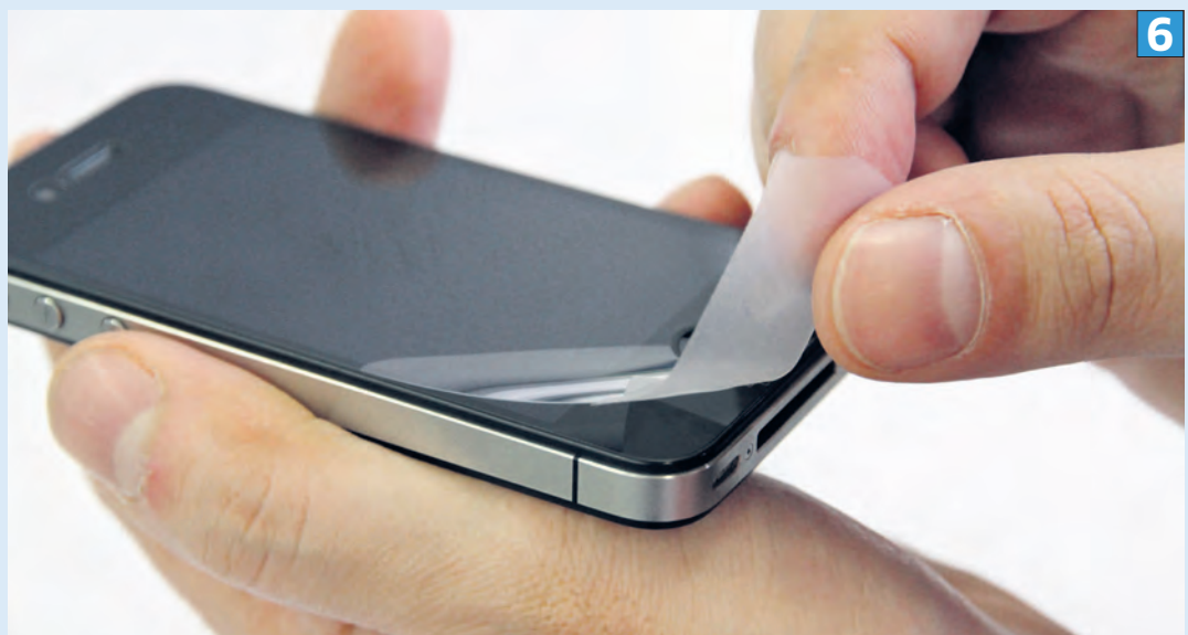
Mittels Klebestreifen können Sie die Folie hochheben und Blasen oder Staub entfernen
